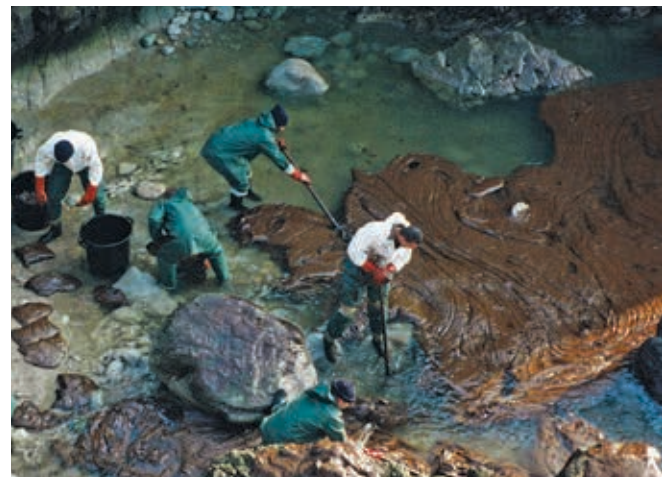
▲ Figura 8: recolección de fueloil pesado emulsionado que muestra un color rojo/marrón típico. Los análisis demostraron que el contenido de agua de la emulsión era inferior al 50%.
