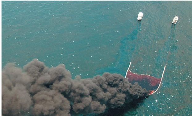
Las líneas de remolque desde los botes de remolque deben generalmente tener una longitud de 75 m (150 pies). Siempre se debe remolcar la barrera hacia el viento de forma que el humo pase por detrás de los botes. Debido a que la velocidad de remolque se mide en relación con la corriente, es posible que la barrera se deba remolcar muy lentamente o incluso a favor del viento para mantener una velocidad lo suficientemente baja en relación a la corriente mientras se remolca hacia el viento.
